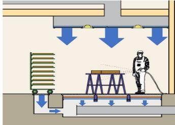
Durch die gleichmäßige, vertikale Absaugung über die in der gesamten Bodenfläche verteilten Absaugkanäle, kann der Arbeitsbereich voll genutzt und beste Oberflächenqualität erreicht werden. Eine flexible Oberflächenbehandlung von
