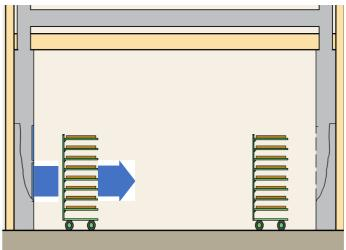
Eigene Trockenräume bieten die Möglichkeit, über eine forcierte Trocknung den Trockenprozess schneller und nachvollziehbarer ablaufen zu lassen.
