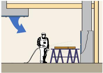
Wenn keine Bodengrube vorhanden ist bzw. es keine Möglichkeit gibt, eine Bodengrube einzurichten oder wenn Teile auf einer Hängebahn geführt werden, findet diese Variante seine Anwendung.
