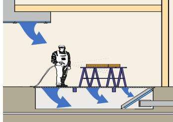
Die Absaugwand wird in eine Bodengrube integriert. Hierbei ist das Spritzen nur in eine Richtung möglich. Bei dieser Ausführung sind die Filtermatten unter dem Gitterrost im Spritzstandgehäuse eingebaut.
